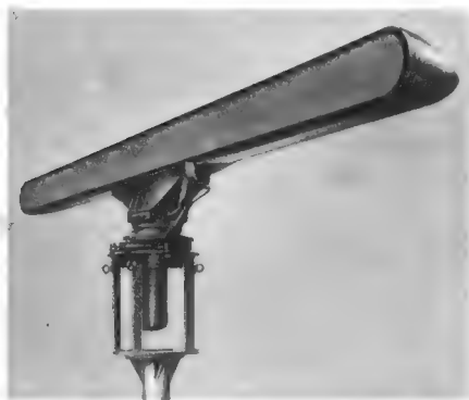
Bild 1. Neue 3-m-Schlitzantenne für 3-cm-Radargeräte für 20 U/min im wasserdichten Gehäuse mit Kunststoffabdeckung der Öffnung; G = 33 dB, horizontale Bündelung besser als 0,75° Halbwertsbreite
